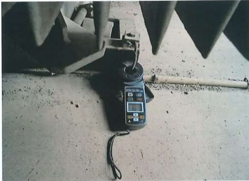
ตรวจสอบสภาพการต่อสายดินหม้อแปลงไฟฟ้า
